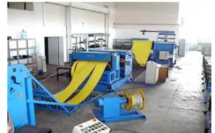
**Линии поперечной, продольной и продольно-поперечной резки металла**
