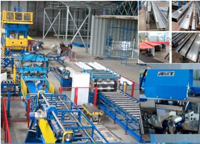
Производство линий профилирующих для изготовления профилей из рулонного металла
