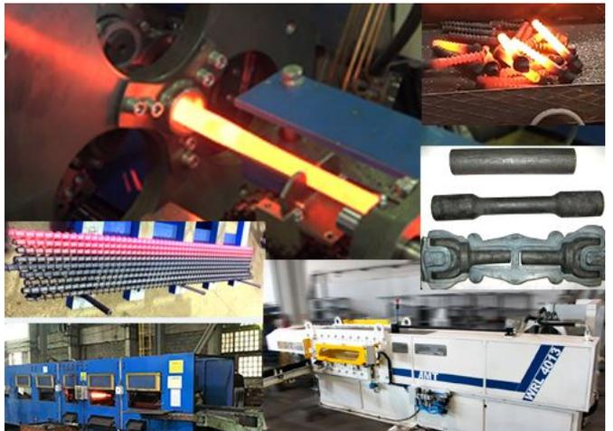
Производство линий поперечно-клиновой и винтовой прокатки для кузнечно-прессовых производств
