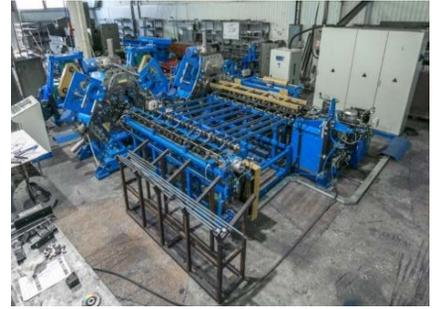
**Линии поперечно-винтовой прокатки**
